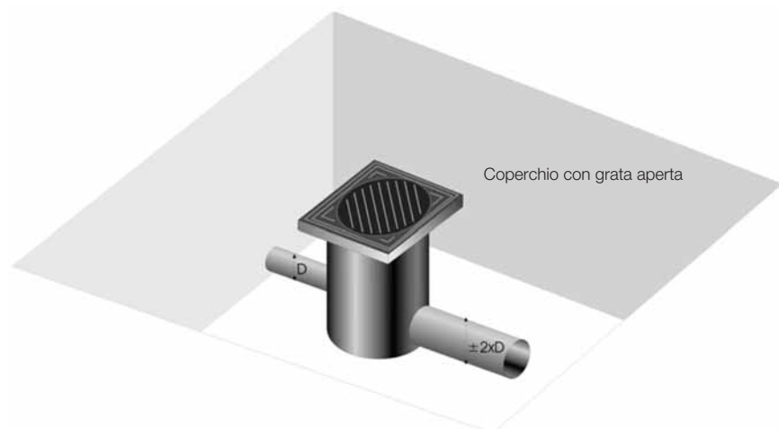
Figura 31. Livello del tubo di scarico.
