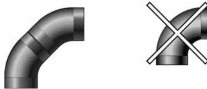
Figura 8. Utilizzare solo curve a 45°, non a 90°.
